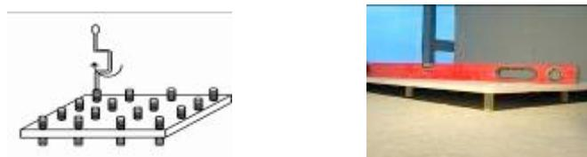
17) Закрепить каждый болт по очереди. Повторно утопить дюбель-гвозди болтов добойником и забить их путем удара по шляпке гвоздя.
